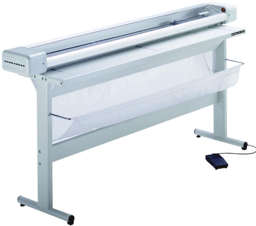
Taglierina elettrica con testa di taglio a lama rotante in acciaio temprato, montata su tubo di scorrimento. Lama fissa in acciaio inox verniciata, montata su un piano di taglio. Raccolta della carta tagliata nel telo raccoglitore. Completa di lampada illuminazione zona di taglio. Parti metalliche verniciate con polveri epossidiche, colore grigio RAL 7035. Supporto in tubolare d'acciaio con piedini regolabili per il livellamento al pavimento. Accessorio: porta rotolo.
